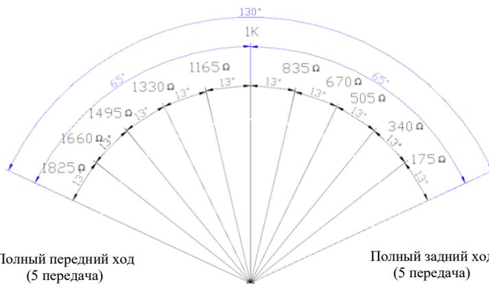
В. Выход сигнала потенциометра при значении сопротивления 5К
