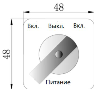
**Внимание:** на рисунке представлен переключатель электропитания, который устанавливается на рабочую панель, может использоваться совместно с указанным выше двойным источником электропитания, подсоединять к клеммам «KZ1 и KZ2».
