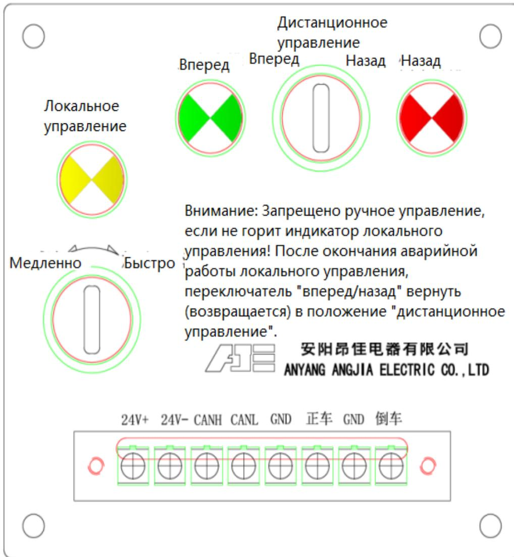
**Внимание: на схеме представлено изображение лицевой панели органа управления AE-4A, функции указаны на схеме, может быть использована в машинном отделении для аварийного управления. Опционально допускается нестандартное исполнение!**
