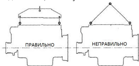
Рис. 2-1. Схема подъема двигателя
