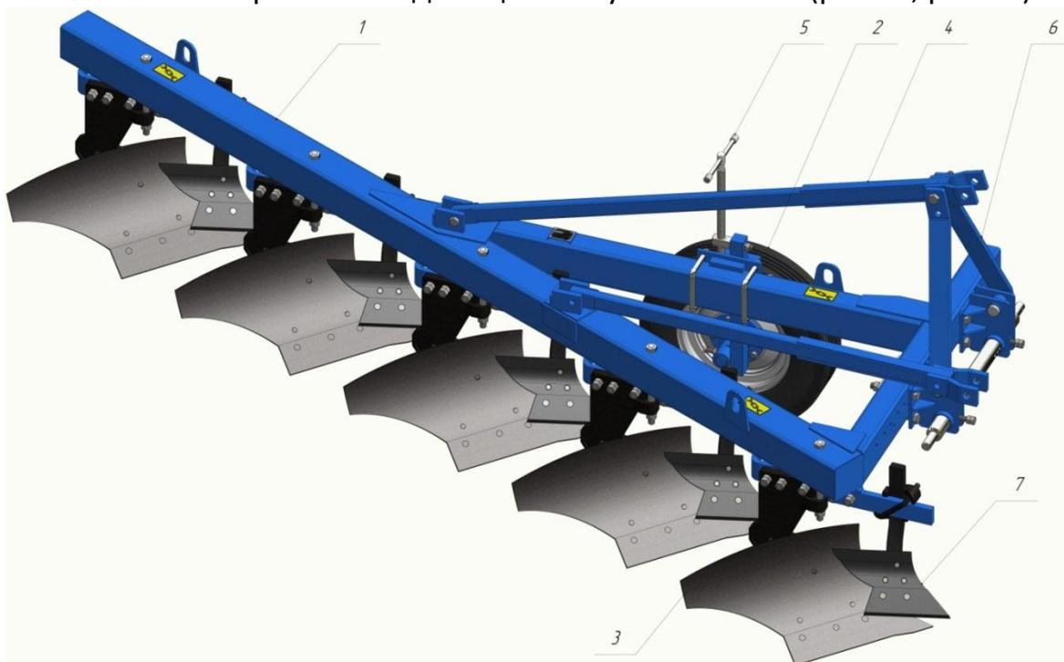
**Рис.1а Плуг пятикорпусной навесной ПЛНУ-5-35П**
