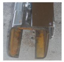
С внешней стороны несущий профиль обрабатывается полимерным покрытием.
