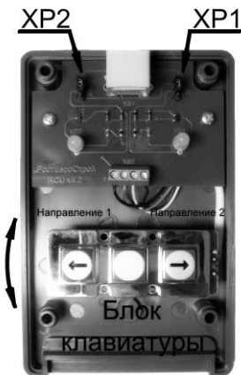
Вид пульта со снятой крышкой
