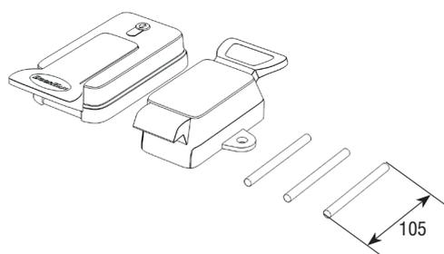
**ЗАМОК РАСПАШНОЙ ДВЕРИ ДЛЯ ОХЛАЖДАЕМЫХ ПОМЕЩЕНИЙ 120 ММ**
