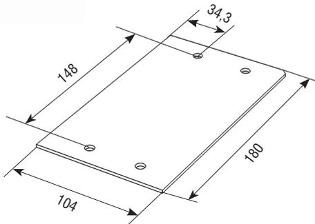
**ЗАКЛАДНАЯ ПЛАСТИНА ПРОФИЛЯ 120 ММ
