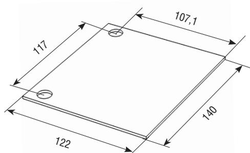
**ЗАКЛАДНАЯ ПЛАСТИНА ПРОФИЛЯ 120 ММ
