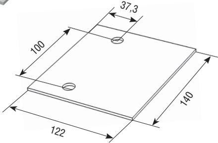
**ЗАКЛАДНАЯ ПЛАСТИНА ПРОФИЛЯ 120 ММ
