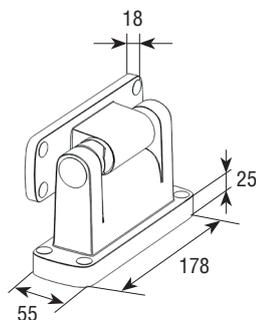
**ПЕТЛЯ ЭКСЦЕНТРИКОВАЯ РАСПАШНОЙ ДВЕРИ ДЛЯ ОХЛАЖДАЕМЫХ ПОМЕЩЕНИЙ 120 ММ**
