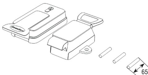
**ЗАМОК РАСПАШНОЙ ДВЕРИ ДЛЯ ОХЛАЖДАЕМЫХ ПОМЕЩЕНИЙ 80 ММ**
