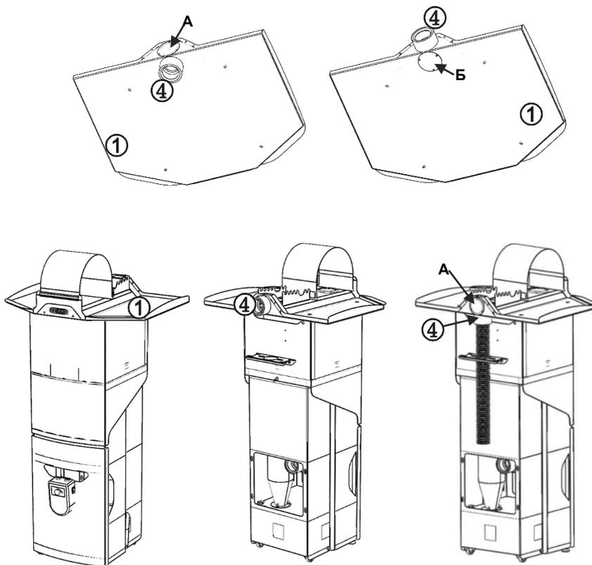
Пример установки ВМУ 1.0 ТЕЙБЛ на корпус УПЗ 7.2 ЦИКЛОН АРТ
