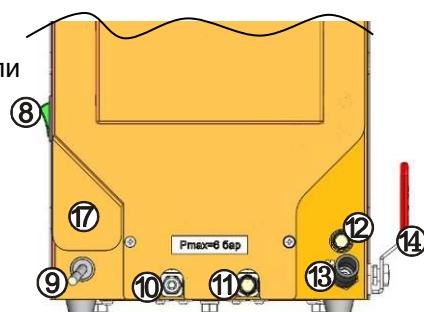
**4.2** Предохранительный клапан установлен внутри стойки и не требует обслуживания при эксплуатации. Срабатывание клапана предусмотрено при давлении в рабочей емкости 6,5...7,0 бар. Аварийный сброс осуществляется через штуцер с глушителем (12).
