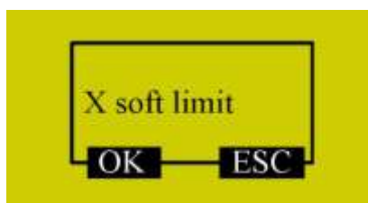
Рис. 6-3 Подсказка о превышении программных пределов Модификация параметра вступает в силу после перезагрузки системы.
