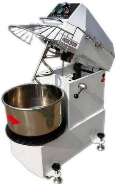
4. Для остановки работы нажмите кнопку «STOP», отключите питание, проверните рукоятку для поднятия верхней части машины и достаньте тесто. Для вынимания чаши поверните ее по часовой стрелке до полной разблокировки.
