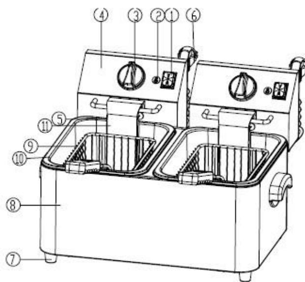
1. КНОПКА ВКЛ. 2. СВЕТОВОЙ ИНДИКАТОР З КОНТРОЛЛЕР ТЕМПЕРАТУРЫ
