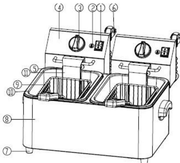
1. КНОПКА ВКЛ. 2. СВЕТОВОЙ ИНДИКАТОР 3. КОНТРОЛЛЕР ТЕМПЕРАТУРЫ
