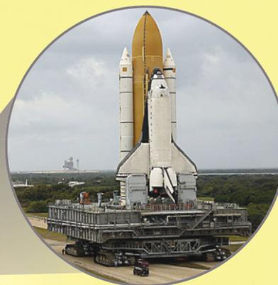
Среди уникальных машин космодрома Канаверал выделяются два транспортёра, которые доставляют ракеты из ангаров к стартовым площадкам. Это машины весом 2400 т, способные перевозить груз весом 5000 т.
