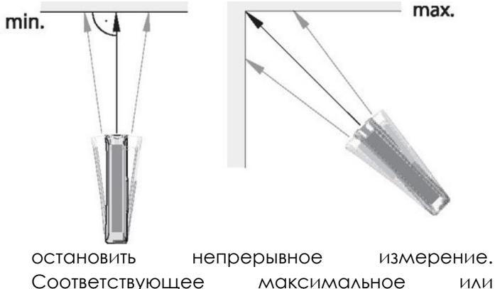
минимальное измерение отображается на дисплее, так же отобразится разница между максимумом и минимумом и на дисплее отобразится последнее измерение.
