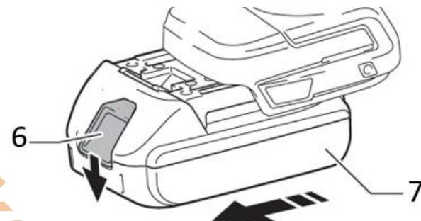
Рисунок 2.1.1. Установка и снятие аккумуляторного блока.
