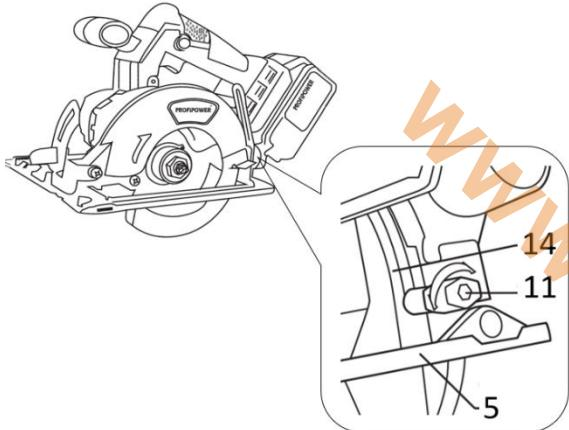
Рисунок 3.1.3. ОГРАНИЧЕНИЕ ГЛУБИНЫ ПИЛЕНИЯ.
