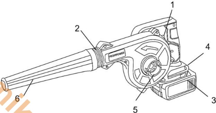
РИСУНОК 1.1. УСТРОЙСТВО ИНСТРУМЕНТА.
