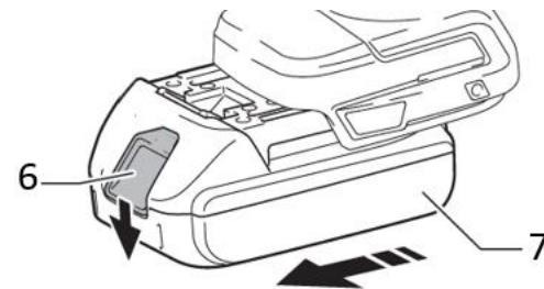
Рисунок 2.1.1. Снятие аккумуляторного блока.
