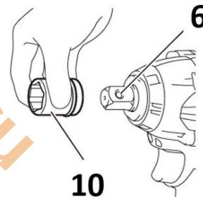
Рисунок 2.2.3. Установка головки без штифта и кольца.
