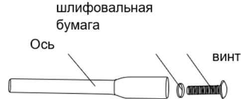
РИСУНОК 2.2.4. УСТАНОВКА ЦИЛИНДРА ШЛИФОВАЛЬНОЙ БУМАГИ.
