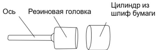
РИСУНОК 2.2.3. УСТАНОВКА ДИСКА ШЛИФОВАЛЬНОЙ БУМАГИ.
