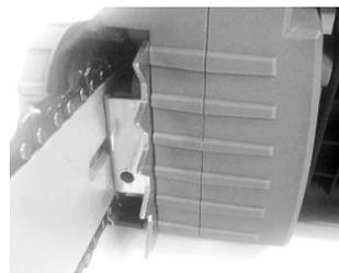
Уловитель цепи служит для улавливания порванной пильной цепи или цепи, выскочившей из направляющей. За счет регулярного технического обслуживания направляющей пилы и правильного и регулярного натяжения пильной цепи можно предотвратить подобные несчастные случаи.
