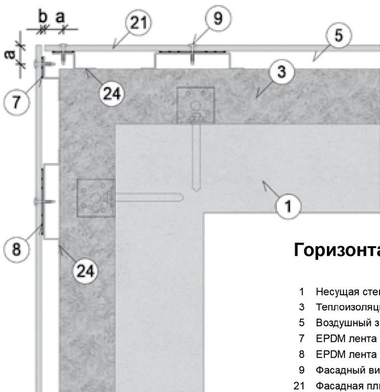
Горизонтальный разрез, внешний угол
