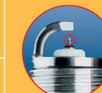
За счет промежуточного электрода из иридия толщиной всего 0,6 мм достигается высокая напряженность поля. В кольцевом зазоре происходят электрические разряды. Тем самым устраняется возможный нагар. Благодаря этому достигаются отличные пусковые качества холодного двигателя и высокая надежность зажигания.
