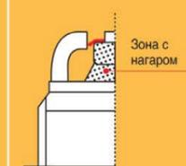
Принцип свечи зажигания с половинной скользящей искрой основан на том, что запальная искра скользит по выдвинутому наконечнику изолятора и удаляет возможные сажевые отложения. Лишь затем происходит искровое перекрытие с промежуточного на боковой электрод и надежное воспламенение воздушно-топливной смеси.
