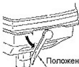
Положение рычага при снятии верхней части кожуха мотора
