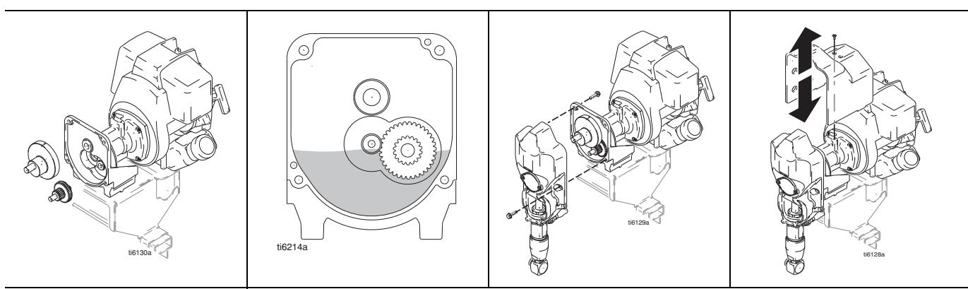
**Установка корпуса привода**
