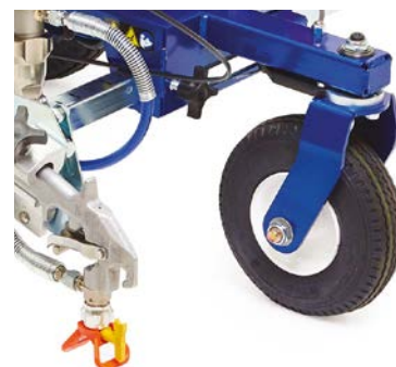
Поворачиваемое переднее колесо
