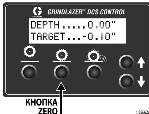
**Долгое нажатие:** Устанавливает нулевую точку на текущей высоте барабана.
