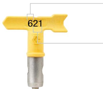
Первая цифра означает величину угла, т.е.  $6 = 60^\circ$ . Умножив первую цифру на 5, Вы получите ширину факела в случае распыления материала на расстоянии 30 см от стены, т.е.  $6 \times 5 = 30$  см.
