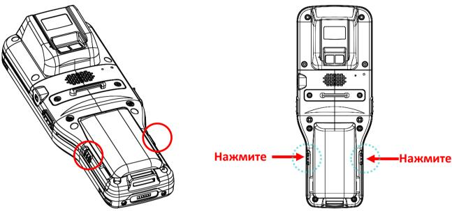
2) Батарея слегка наклонится вверх и готова к извлечению. Поднимите основную батарею за нижний край, чтобы снять её.
