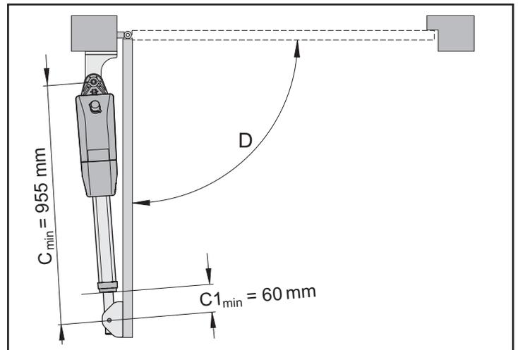
6. Привести вручную ворота в выбранное положение "Ворота ОТКР". Соблюдать максимально возможный угол открытия D из таблицы размеров "А"/"В".
