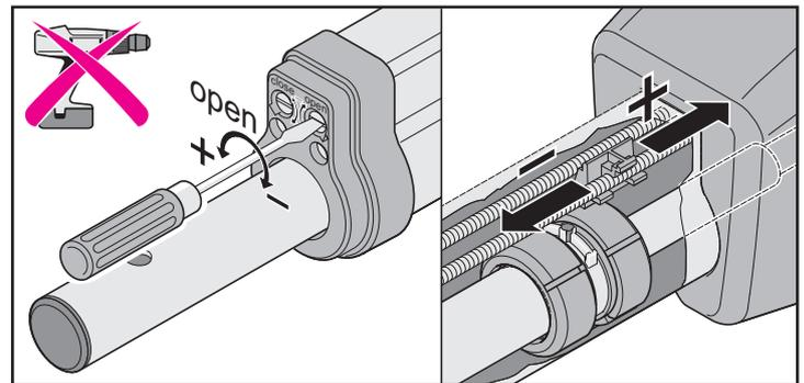
При необходимости можно подрегулировать крайнее положение с помощью отвертки.
