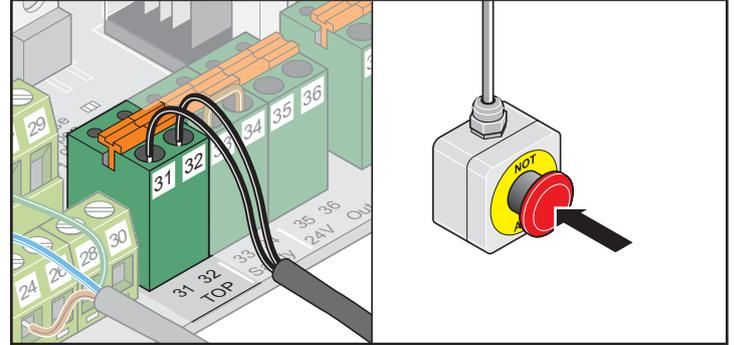
Перед подключением снять проволочную перемычку.
