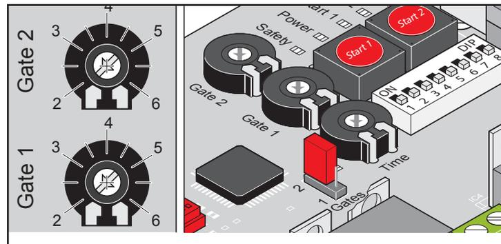
С помощью потенциометра "Ворота 1-створ. (M1)/Ворота 2-створ. (M2)" (Gate 1 (M1)/Gate 2 (M2)) на блоке управления производится настройка длины створки ворот. На основании этой настройки определяется скорость хода и допуск по усилию для соответствующей створки ворот.
