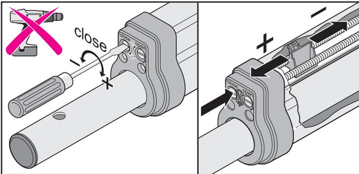
При необходимости можно подрегулировать крайнее положение с помощью отвертки.
