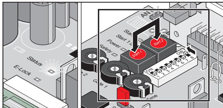
1. Нажать кнопки "Пуск 1 + Пуск 2" (Start 1 + Start 2) одновременно и удерживать их нажатыми.
