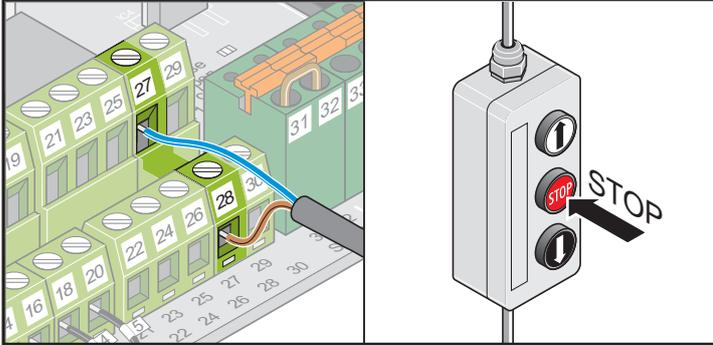
Перед подключением снять проволочную перемычку.
