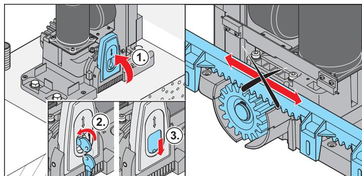
1. Откинуть рычаг фиксатора кверху
