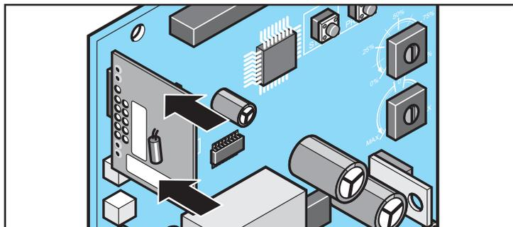
1. Вставить плату приемника в блок управления согласно схеме.
