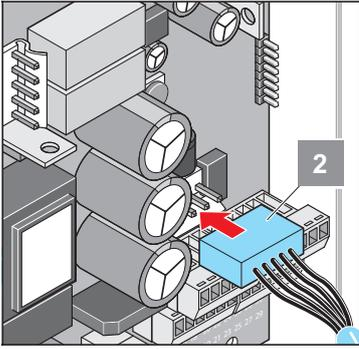
4. Снять крышку блока управления и подключить второй конец соединительного провода к блоку управления (2)
