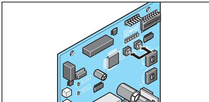
1. Одновременно нажать кнопки «Start» («Пуск») и «Prog» («Прог.») и удерживать их нажатыми.
