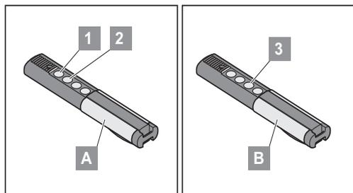
1. Нажать кнопки 1 + 2 запрограммированного ручного пульта-передатчика (А) и удерживать в течение 5 секунд, пока на приемнике радиосигналов не загорится светодиод канала 1.
