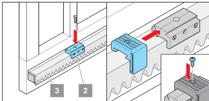
4. Привинтить нижнюю часть (2) держателя магнита в нужное место кожуха зубчатой рейки (3)
