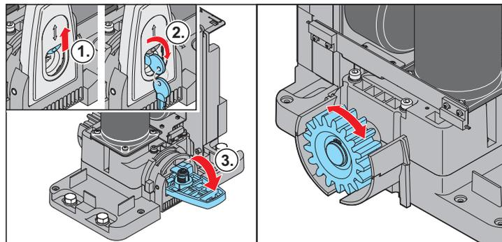
1. Снять пылезащитный колпачок
