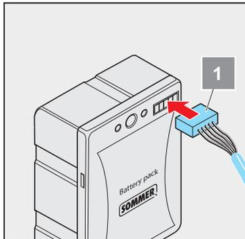
3. Вставить штекер соединительного провода в аккумуляторную батарею (1)
