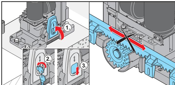
1. Откинуть рычаг фиксатора кверху
