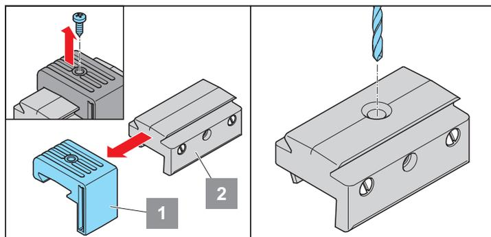
1. Вывернуть винт верхней части (1) держателя магнита
