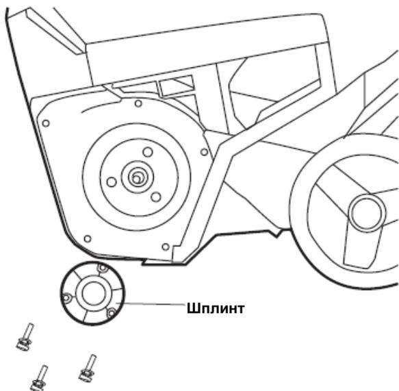
4. Снимите привод, ось шнека, прокладку и старый шнек. Затем снимите вводные фиксирующие блоки со старого шнека и установите их на новый.
