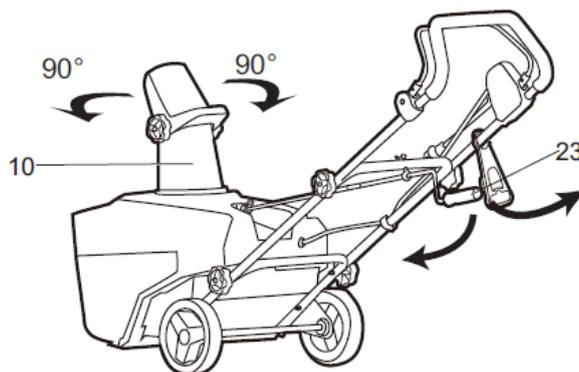
Разгрузочный желоб может поворачиваться на 180° для изменения направления выброса снега.
