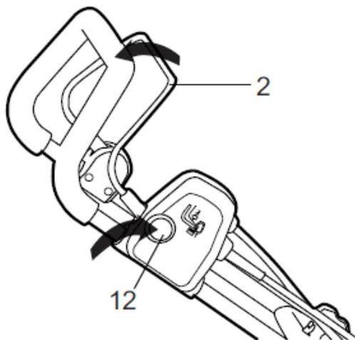
1. Удерживая кнопку-предохранитель (12), потяните за скобу включения (2), чтобы запустить устройство.
