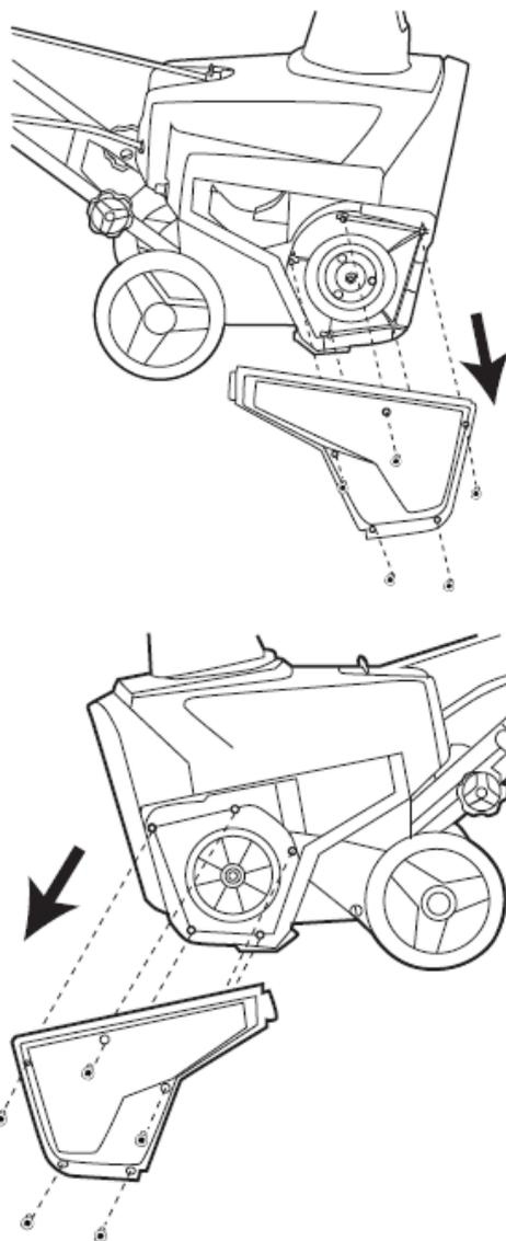
2. Снимите ремень, открутите гайку, а затем снимите накладку, большой шкив и прокладку.
