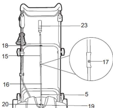
1. Соедините части (15) и (16) штока ручки с помощью одного винта (17), входящего в комплект поставки.
