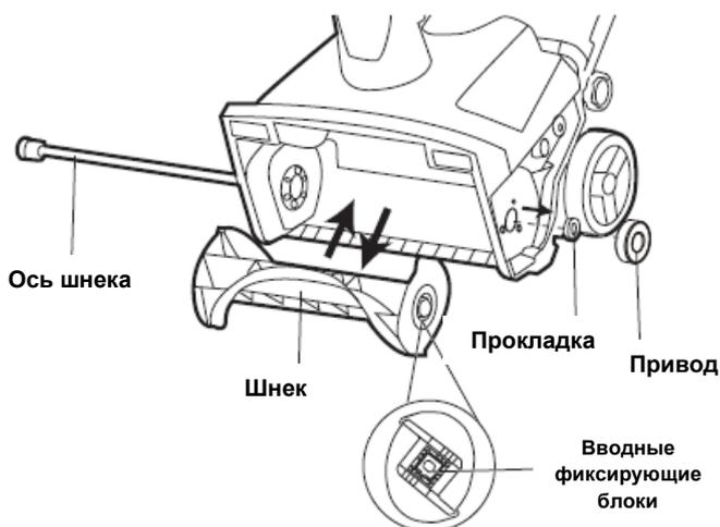
5. Установите новую ось шнека, шнек, прокладки и привод в соответствующем порядке.
