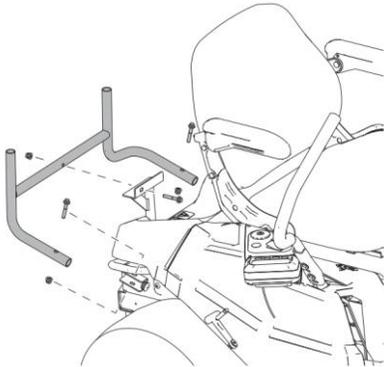
3. Закрепите нижнюю трубу на деке косилки, вставив фиксирующие штифты в паз крепления.
