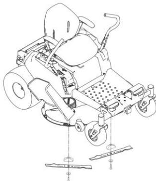
1. Снимите гайку, фиксатор, ножи и шайбы. Замените стандартные ножи на специальные, входящие в комплект травосборника..
