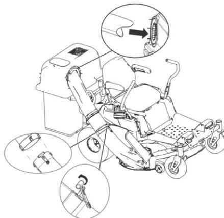
9. Совместите углубления на верхней трубе с выступами на нижней трубе. Зафиксируйте соединение верхней и нижней труб резиновой застежкой, надежно зацепив ее за штифт на верхней трубе дефлектора.
