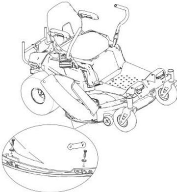
5. Совместите два отверстия верхней крышки с двумя стойками рамы и нажмите, чтобы закрепить их на месте.
