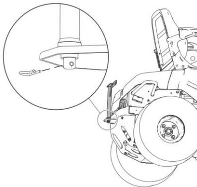
2. Прикрепите раму к двум монтажным пластинам, расположенным на задней части косилки. Вставьте болты и гайки в монтажные отверстия и не затягивайте их. Закрепите опорную стойку на держателе с помощью болта и гайки и затяните их.
