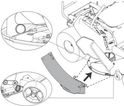
4. Совместите два отверстия нижней трубы с отверстиями на деке и зафиксируйте их винтом и шайбой.
