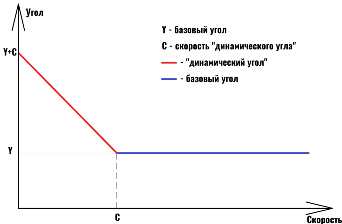
Рисунок 3.18 График зависимости динамического угла от скорости
