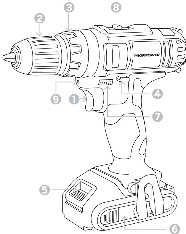
Рисунок 1.1. Устройство инструмента
