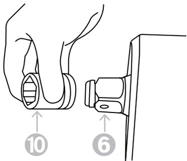
Совместите отверстие в боковой поверхности ударной головки «10» (рисунок 2.2.3) со штифтом на квадратном хвостовике «6» и нажмите на головку, чтобы она зафиксировалась. При необходимости слегка постучите. Чтобы снять ударную головку, просто потяните ее.
