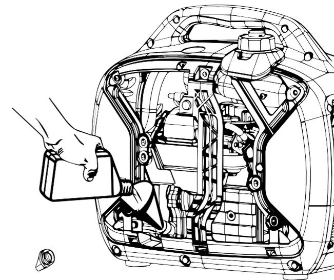
3 Закрутите крышку маслозаливной горловины и установив боковую панель обратно, закрепите винтом. Проверьте уровень масла в картере с помощью щупа.
