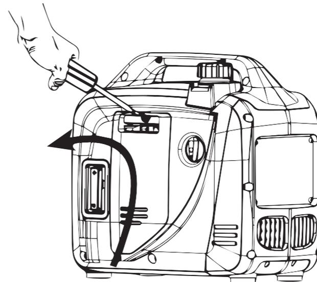
2 Установите генератор на ровную поверхность. НЕ наклоняйте генератор во время добавления масла. Это может привести к переполнению масла и/или к утечке масла в места, для которых оно не предназначено. Снимите крышку маслониливной горловины, как показано на рисунке. Используя воронку (входит в комплектацию) заполните 0,35 литра SAE 10W-30.
