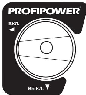
Многофункциональный переключатель управления топливным клапаном и дросселем. Для запуска генератора, при холодном двигателе, вращайте мультипереключатель по часовой стрелке из положения ВЫКЛ. в положение ВКЛ., затем быстро потяните за ручной стартер для запуска.
