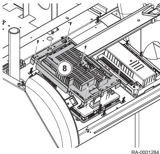
8. Ослабить винты (7 шт.) и снять панель блока управления
