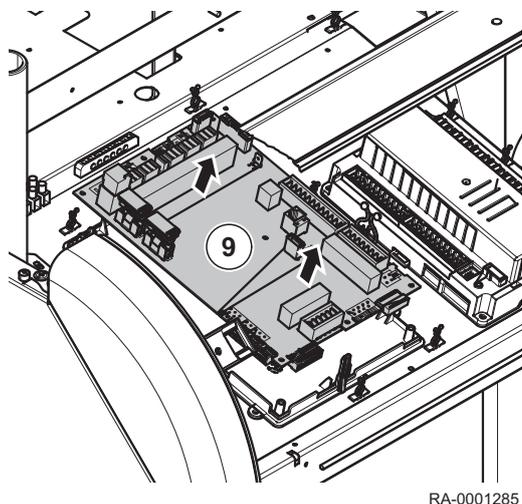
9. Снять неисправный блок управления
