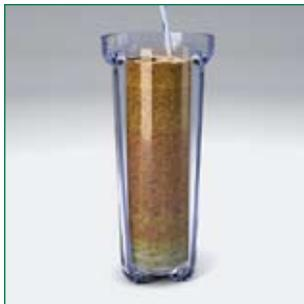
■ Установить картридж со снятой крышкой в корпус и заполнить корпус раствором соли (примерно 0,5 л.) доверху, осторожно заливая его через картридж и следя за тем, чтобы смола не вылилась с раствором через верх. Оставить в таком состоянии на 8-10 часов.
