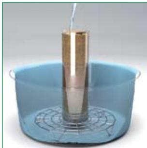
■ Отвернуть верхнюю крышку умягчающего картриджа рукой. Пролить через картридж 2 л. раствора соли, следя, чтобы смола не вылилась с раствором через верх (при пропускании через картридж БС раствора соли возможно бурление жидкости из-за выходящего из слоя смолы воздуха, что является нормальным).
