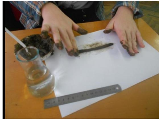
Рисунок 3-4 - Окраска почвы и определение механического состава почвы
