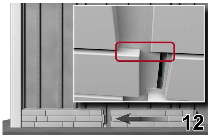
Каждый новый ряд старайтесь начинать с произвольным, неравномерным смещением. Обрезки, полученные при этом, пойдут на завершение ряда. (рис. 13, 14)
