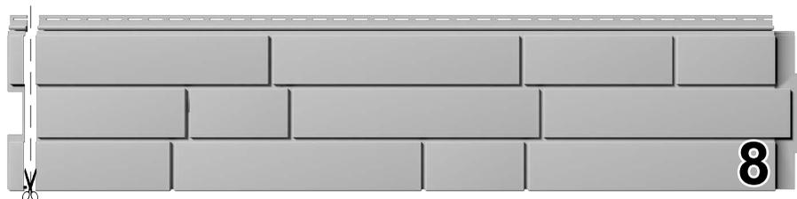
Вставьте панель в стартовые элементы и задвиньте в паз Декоративной системы. (рис. 9, 10)
