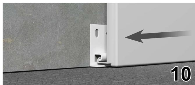
Оставляйте зазор между панелями ЯФАСАД и декоративной системой 8-10 мм для компенсации теплового расширения. (рис. 11)
