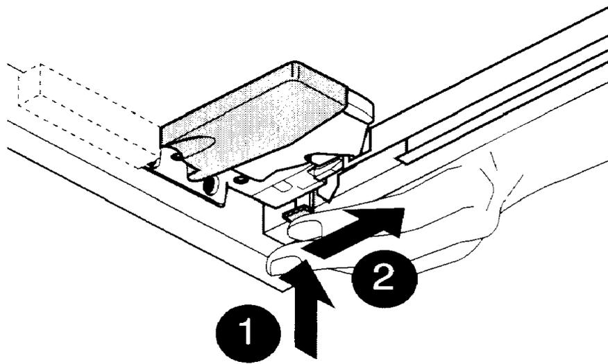
Для регулировки фасадов ящиков нижних шкафов по высоте слегка ослабьте винт 2 и расположите фасад на требуемом уровне при помощи регулировочного винта 3, затяните винт 2. Для регулировки фасада по ширине надавите на язычки 1 с обеих сторон, немного приподнимите фасад и передвигайте его в стороны. Отпустите язычки 1.
