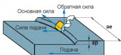
Три основных силы резания при фрезеровании
