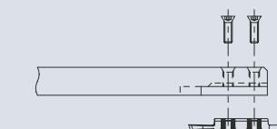
две пары винтов для обоих типов систем крепления поставляются с каждой державкой
