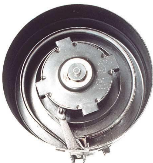
Барабанный магазин на 71 патрон в разобранном состоянии
