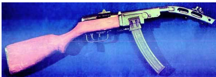
ППШ-41, модификация с искривленным стволом и коробчатым магазином на 35 патронов
