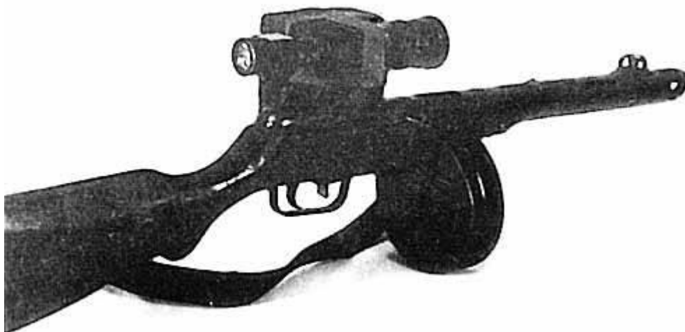
ППШ-41 модификация с прибором ночного видения
