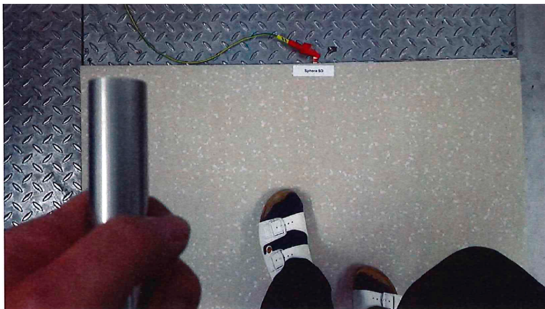
Рисунок 5: Испытание хождением для изучения электростатической защиты обуви и напольного покрытия в сочетании с человеком.
