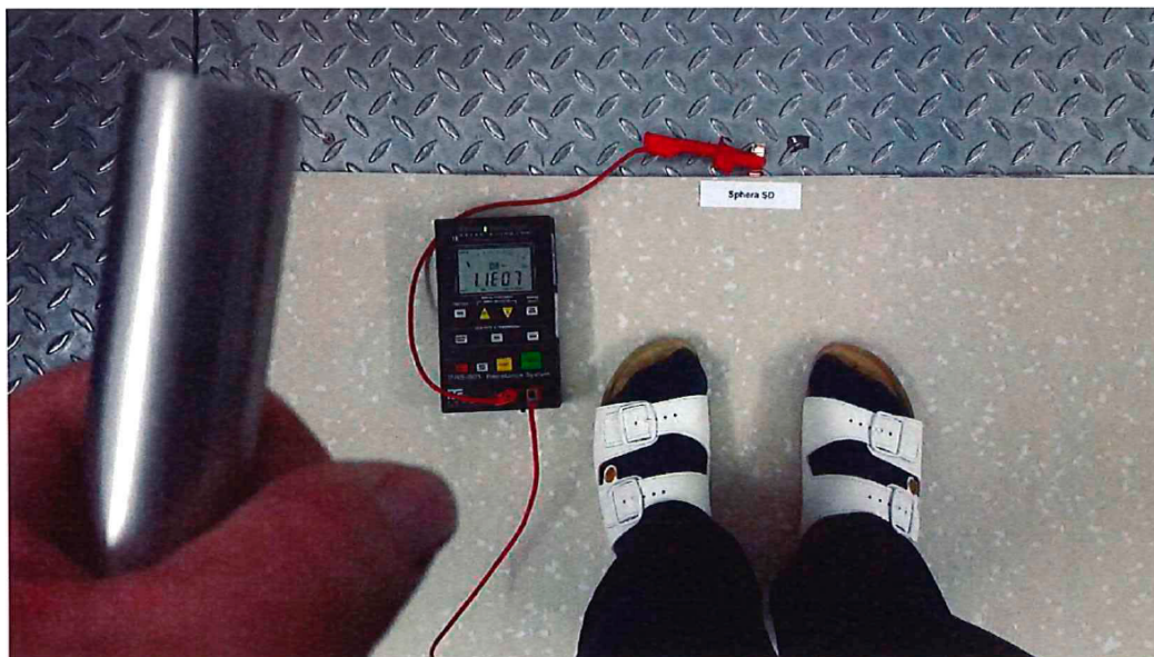
Рисунок 4: Измерение сопротивления системы человек (ручной электрод) - обувь (обувь с защитой от статического электричества) - напольное покрытие (с точкой заземления) в соответствии с EN 61340-4-5.
