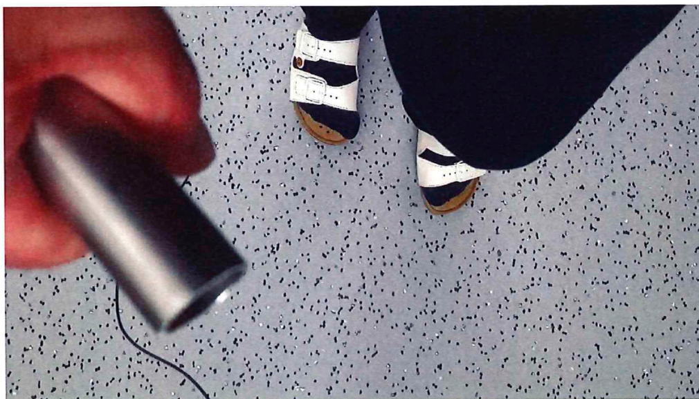
Рисунок 1: Оператор оценивает электростатическое поведение линолеума с помощью испытания ходьбой и обуви с защитой от статического электричества.
