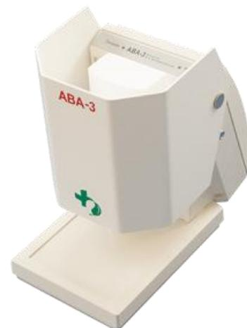
Прибор **АВА-3** предназначен для измерения концентрации особо опасных химических элементов (*кадмий, свинец, медь, ртуть, мышьяк, йод, таллий, селен и другие*) на уровне ПДК и ниже в объектах окружающей среды, воде, атмосфере, почве, пищевых продуктах, биообъектах, лекарственных препаратах и в других объектах в соответствии с аттестованными методиками измерений и ГОСТами.
