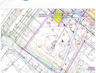
2 Выпуска водопровода на произв. нужды труба ПЭ100 SDR17 Ф160х9.5(уточнить проек
