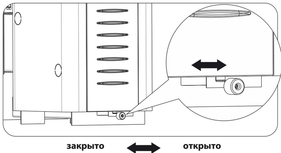
Рисунок 7. Регулировка шибера
