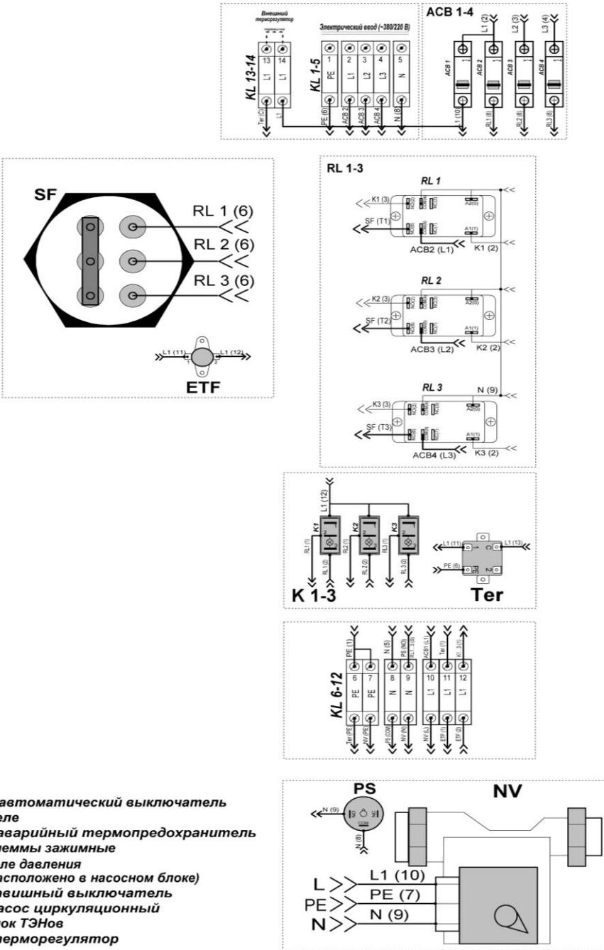
Рисунок 4. Электротехническая схема котла.
