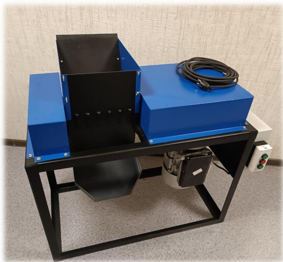
Угольная дробилка ДУ-01 предназначен для получения фракционного угля (5-40 мм.): «орех», «семечка», который предназначен для использования в котлах с порционной механизированной подачей топлива (шнек, поршень).
