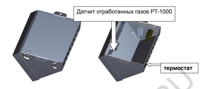
Монтирование проводов к комнатному термостату или к датчику выхлопных газов PID осуществляется при откручивании нижней части контроллера. Провода термостата монтируем в предназначенном месте с помощью зажимов, а датчик выхлопных газов в месте, обозначенном PT1000.
